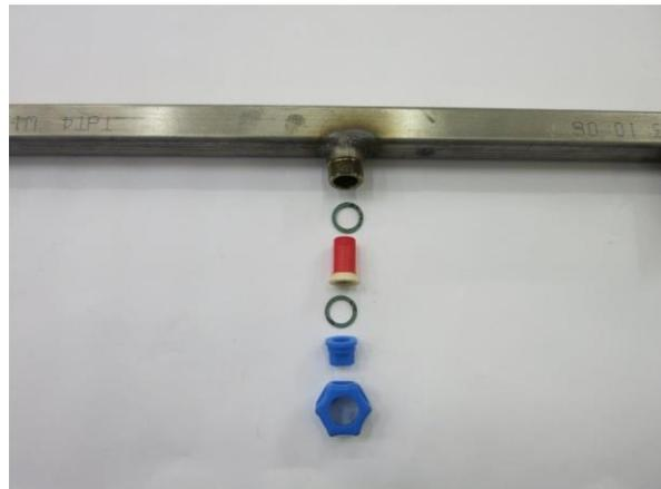
Düsenaufbau mit Rückschlagventil, große Düsen
