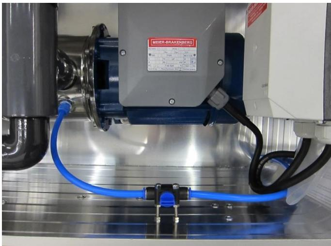
Vollen Wassermengenzulauf aus Entlüftung abwarten. Blau-schwarzen Kugelhahn schließen. Netzanschluss 230V/50Hz für Pumpenbox über Schutzkontaktsteckvorrichtung herstellen.
