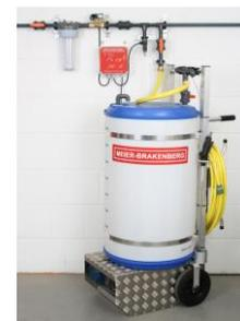
Öffnen des entsprechenden Abteilhahnes. Einschalten der Pumpe bis Behälter geleert ist. Entsprechend der Leitungslänge Wasser in Behälter einfüllen (meist 10 L ausreichend) und Leitung leer spülen.
